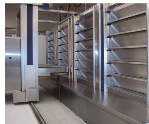
Voorbeeld van een installatie op maat: 4 x HEIN ELECTRO van 6 verdiepen met automatisch inschiet en uitoven systeem HEIN SPIDER.
